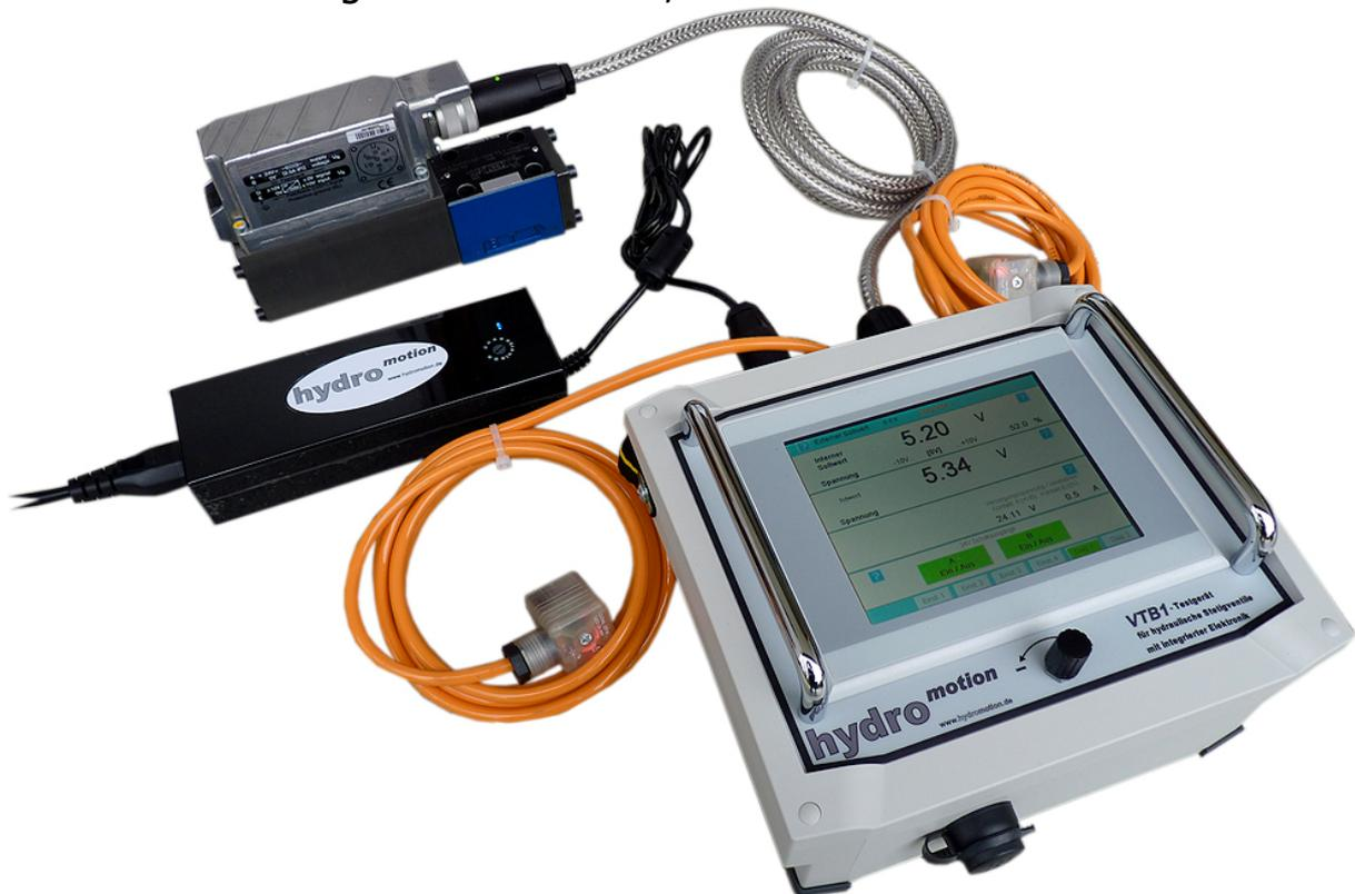
Bei modernen Hydraulikventilen mit integrierter Elektronik (**O**n **B**oard **E**lektronik) ist das elektrische Signalkabel, ohne weitere Messbuchsen oder optischen Rückmeldungen, direkt mit dem Ventil verbunden.
