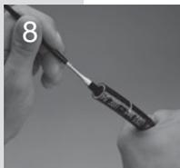
Используя смазочное масло SAE 20, слегка смажьте внутреннюю поверхность конца шланга. (Для кислородных систем используйте мыльный раствор без содержания масла.).
