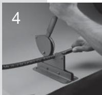
С помощью ручного режущего инструмента Parflex РНС или другого острого резака отрежьте перпендикулярно шланг необходимой длины.
