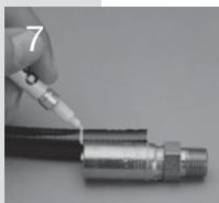
Нанесите на край шланга отметку на расстоянии глубины вставки от его конца (Глубина вставки = размер «А» минус размер «В» в соответствии с таблицами фитингов для шлангов в разделах с В по Е)
