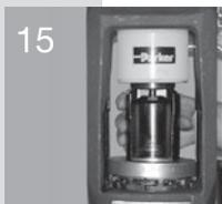
Надвиньте нажимной цилиндр на болт с буртиком.
