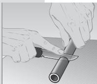
Обрежьте шланг перпендикулярно острым ножом. При необходимости смажьте конец фитинга водой или мыльным водным раствором (5% жидкого мыла + 95% воды) для облегчения сборки.
