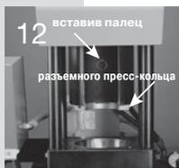
При полностью поднятом нажимном цилиндре расположите заднюю половину разъемного пресс-кольца в задней части нажимного цилиндра. Зафиксируйте кольцо, вставив палец выдвижной планки.
