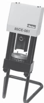
Пресс KarryKrimp® 2 является портативным, компактным и прочным. Он полностью обеспечивает обжим шлангов с номинальным диаметром от DN 6 до DN32. Модель 85C-061 включает в себя обжимной станок, съемную стойку, пресс-кольца и соединительный шланг с быстроразъемным соединением. Для шлангов Parker, армированных текстильным волокном и стальной проволокой, до 4SP DN 32, и 4SH/100 R13 до DN 25. Укомплектован шлангом в сборе и быстроразъемным соединением, 2 пресс-кольцами и съемной стойкой.
