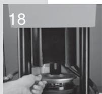
было вставлять и извлекать фитинги с угловой трубкой. Вставьте переднюю половину разъемного пресс-кольца так, чтобы направляющий штифт задней половины совпал с отверстием передней половины.
