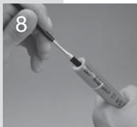
Используя смазочное масло SAE 20, слегка смажьте внутреннюю поверхность конца шланга. (Для кислородных систем используйте мыльный раствор.)
