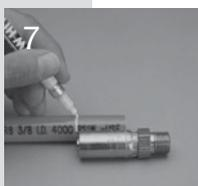
Нанесите на край шланга отметку на расстоянии глубины вставки от его конца (Глубина вставки = размер «А» минус размер «В» в соответствии с таблицами фитингов для шлангов в разделах с В по Е).
