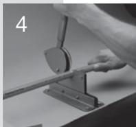
С помощью ручного режущего инструмента Parkflex PNC или другого острого резака отрежьте перпендикулярно шланг необходимой длины.
