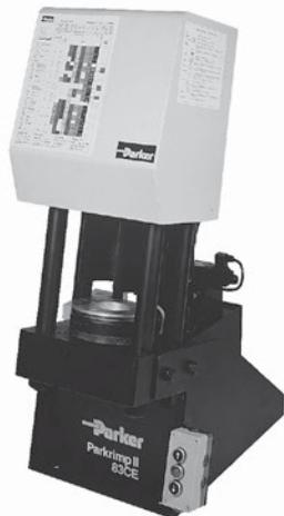
Для шлангов Parker с оплетками из текстиля или стальной проволоки, а также со спиральными слоями из стальной проволоки номинальным диаметром до DN 50. С гидравлическим устройством и рамой основания, но без штамп-комплектов.
