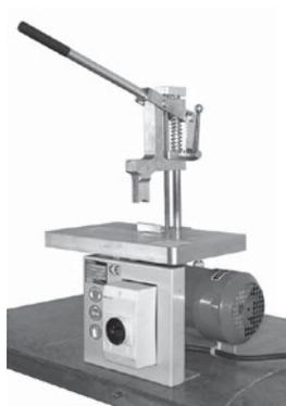
Отрезной станок для шлангов polyflex ST250 используется для отрезки шлангов с металлическим или стекловолоконным армированием (до шести спиральных слоев) до размера DN 25. Этот отрезной станок подходит для мелких партий, одиночных труб и ремонтных мастерских.
