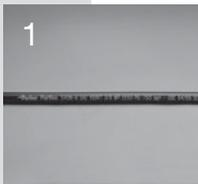
Проверьте, соответствует ли рабочему заданию тип и размер шланга, напечатанные на его оболочке.
