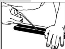
Слегка смажьте маслом область между разделяемыми шлангами. Масло предназначено для уменьшения трения лезвия ножа.
