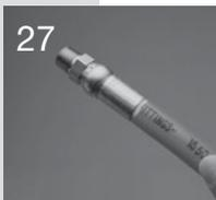
Осмотрите отметки глубины вставки на концах фитингов. Отметки вставки должны быть видны и находиться в пределах 3 мм от нижнего края гильзы фитинга.
