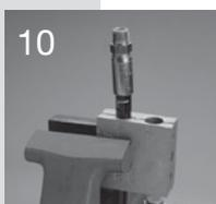
Посадите фитинг на шланг следующим образом: Используя зажимной блок для тисков Parker VBS или VBL, поместите шланг с фитингом в соответствующее отверстие зажимного блока, и зажмите его в тисках.
