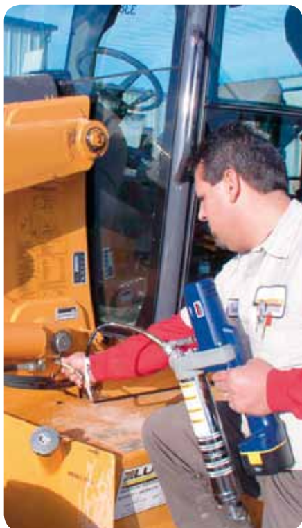
Система наполнения и дозирования BDS направлена на один смазываемый узел.
