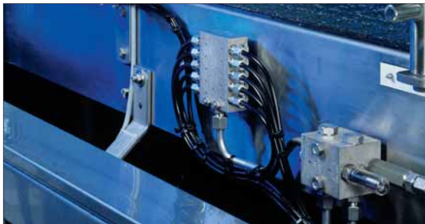
Ленточный транспортер с двухлинейным и прогрессивным питателями
