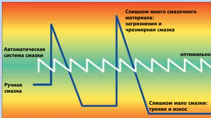
Сравнение автоматическая/ручная смазка
