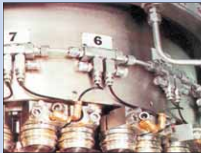
Механизм с однолинейными питателями
