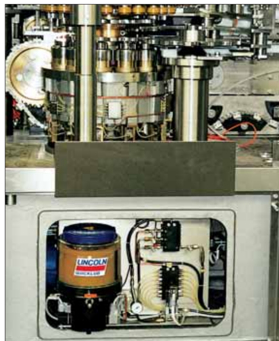
Разливочная машина с прогрессивной системой Quicklub
