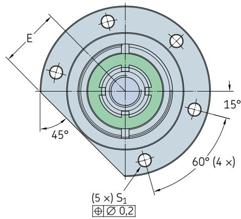
**Винт Подшипниковая опора**
