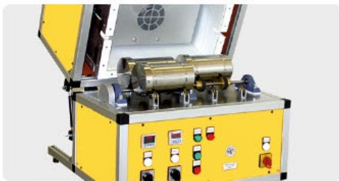
Машина для испытания стабильности при перекачивании
