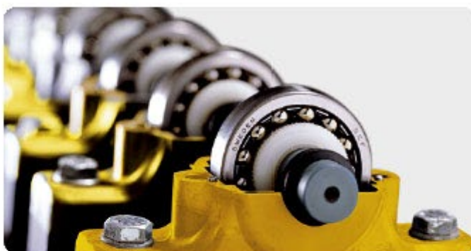
Машина Етсог для испытания пластичной смазки
