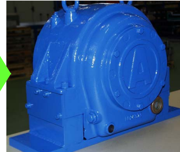
Модернизированный корпус для подшипника CARB
