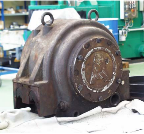
Старый корпус на призмах для сферического роликоподшипника
