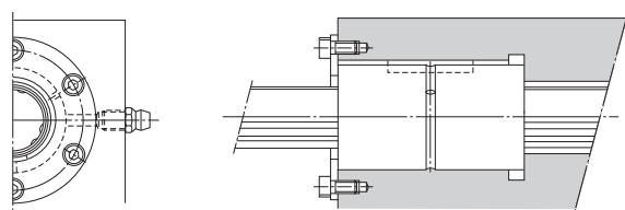
Рис.1 Примеры монтажа шлицевой гайки
