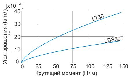
Рис.7 Сравнение нулевого зазора модели LBS и LT
