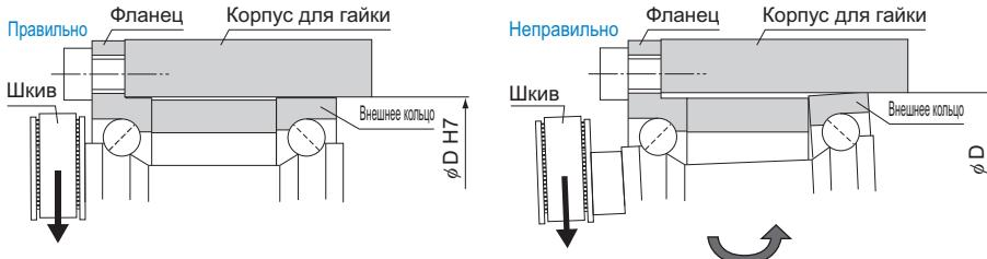
Примечание) Поскольку наружные кольца имеют раздельную конструкцию, важно учитывать допуск по внутреннему диаметру корпуса для гайки (рекомендуется использовать H7), чтобы избежать смещения наружного кольца, находящегося на противоположной стороне от фланца.
