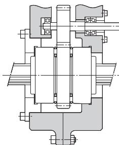
Рис.2 Примеры монтажа шлицевой гайки
