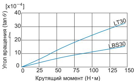
Рис.8 Сравнение зазора CL модели LBS и LT
