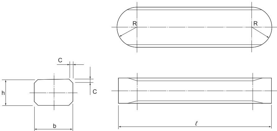
Таблица4 Стандартные шпонки для моделей SLS и SLS-L
