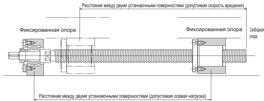
Рис.8 Способ установки ходового винта: Фиксированная опора - свободная опора
