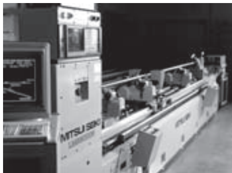
Лазерная автоматическая установка для измерения шага резьбы
