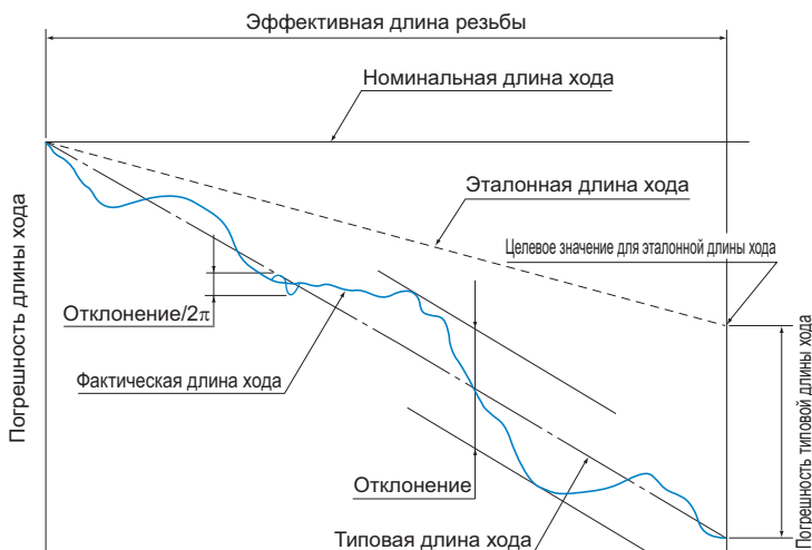
Рис.1 Термины, применяемые при определении точности угла подъема резьбы
