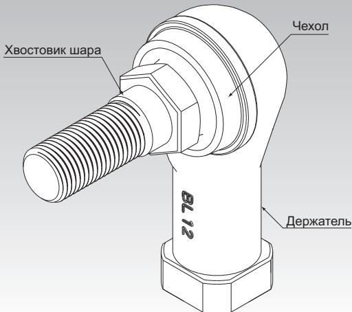
Рис.1 Конструкция шарового шарнира тяги модели BL
