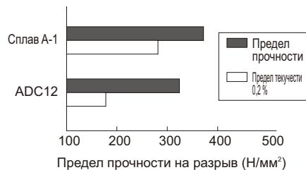
Рис.3 Пределы прочности и предел текучести сплавов ТНК А-1 и ADC 12
