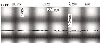
Шероховатость сферической поверхности шара с хвостовиком
