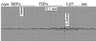
Шероховатость сферической поверхности шара с хвостовиком
