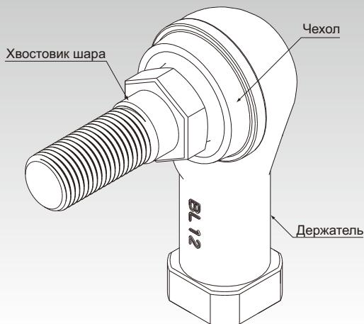
Рис.1 Конструкция шарового шарнира тяги модели BL
