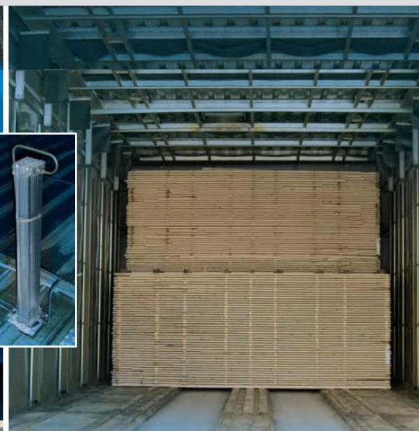
Просушивание досок под гнетом: это предотвращает их коробление
