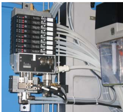
Настройка сервопривода (цилиндра) через блок клапанов HF03 с управлением по цифровой шине
