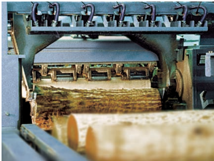
Для получения облицованного шпона (фанеры) с подходящего бревна снимают кору при помощи специального ножа для зачистки
