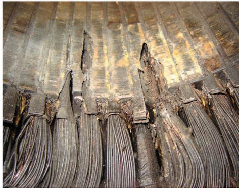
У, казалось бы, самых простых и надежных асинхронных электродвигателей с короткозамкнутым ротором, одновременно и самых распространенных, нередко выходит из строя ротор вследствие повреждения его стержней.
