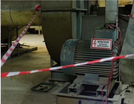
По сути, это мобильная переносная лаборатория, так как все тесты выполняются одним прибором. Данный полный комплекс испытаний занимает от 10 до 30 минут, при этом для подготовки электродвигателя к диагностике не требуется разборка его схемы соединения, а достаточно всего отсоединить питающий кабель с любой стороны.
