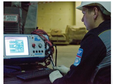
Это становится возможным с применением диагностического оборудования SKF Baker — усовершенствованного анализатора обмоток электрических машин AWA-IV. С его помощью в максимально короткое время производятся:
