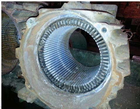
Согласно различным европейским исследованиям, причинами выхода из строя электродвигателей является неисправность: статора — до 40%, ротора — до 10 %, подшипников — до 45% всех случаев.
