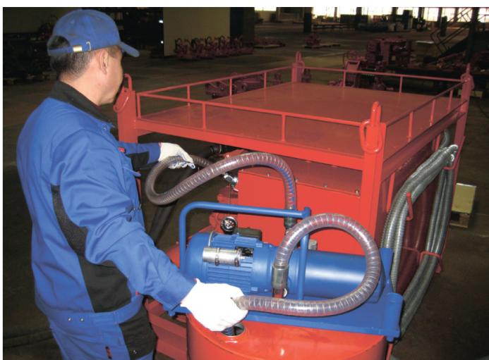
▲ Рис. 6. Заправка гидравлических станций
