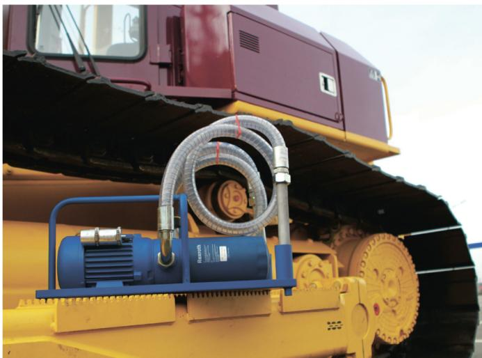
▲ Рис. 4. Очистка мобильных систем (бульдозер)
