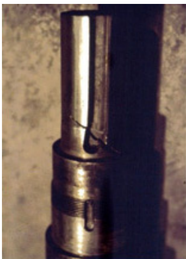
Фото 2. Иногда пластичный вал выходит из строя таким же образом, как и хрупкий, как вышел из строя этот вал в двигателе мощностью 150 кВт, 3600 об/мин, который внезапно перестал работать.
