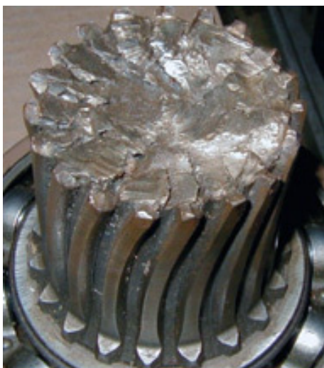
Фото 1. Этот вал подвергался сильным перегрузкам вследствие напряжения кручения.
