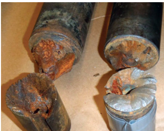
Фото 9. Валы насоса вышли из строя из-за усталости при кручении, усиленной снижением прочности в результате коррозии, а не изгибом при вращении.
