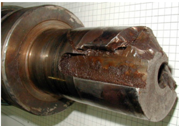
Фото 7. Из-за плохого (слабого) крепления муфт на этом валу двигателя ступица многократно прижимала шпонку к стороне шпоночной канавки, пока не образовалась усталостная трещина.
