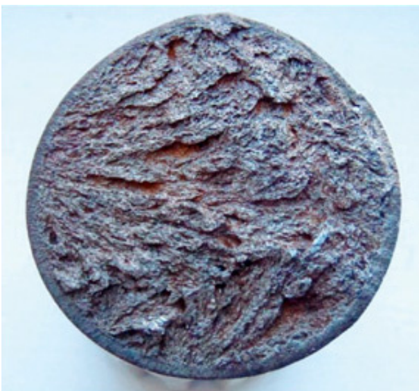
Фото 4. На упрочненном шпоночном участке вала гидронасоса показаны доказательства хрупкого излома, вызванного однократным изгибающим усилием.
