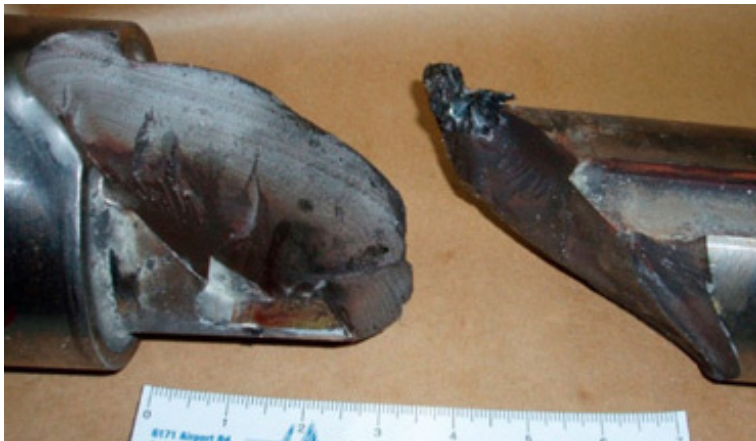
Фото 8. Усталостное разрушение при кручении на этом валу вентилятора произошло вскоре после установки частотно-регулируемого привода.
