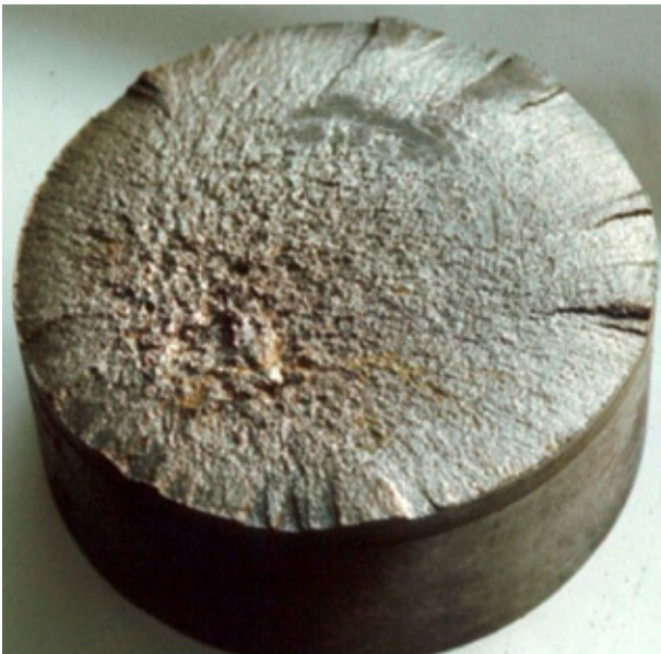
Фото 5. Вал этого двигателя мощностью 150 кВт, 1180 об/мин, вышел из строя менее чем за день в результате сильно изношенных шкивов на ременной передаче.
