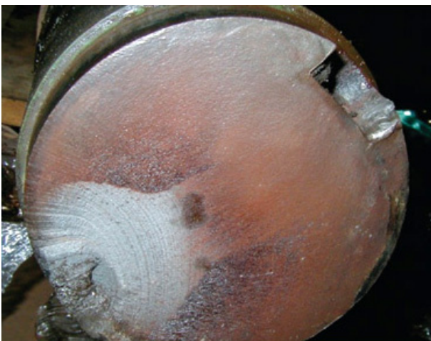
Фото 6. Это медленно растущее разрушение привода элеватора сталепрокатного стана вызвано фреттинг-коррозией, которая значительно уменьшила усталостную прочность вала.
