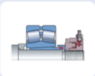
Гидравлическая гайка HMV..E используется для монтажа подшипника на стяжную втулку.
