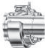
Рисунок 8. HMV гайка и стопорное кольцо в положении для сдавливания переходной втулки.
